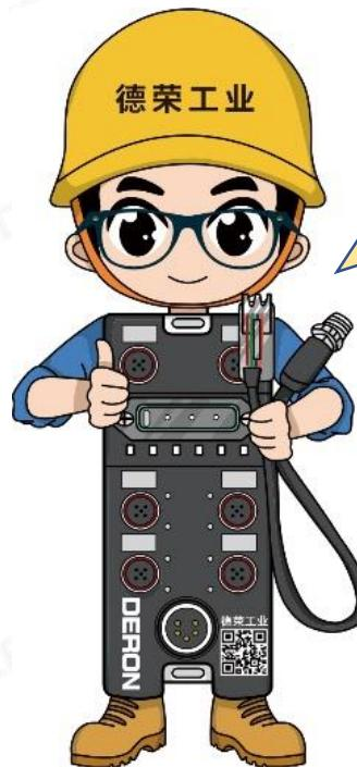
IO-Link是一种点对点的、串行数字通信协议，它的目的是在传感器/执行器与控制器（PLC）之间进行周期性的数据交换。
